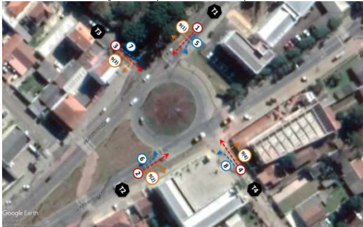
Figura 57: Localização e movimentos da intersecção 04
