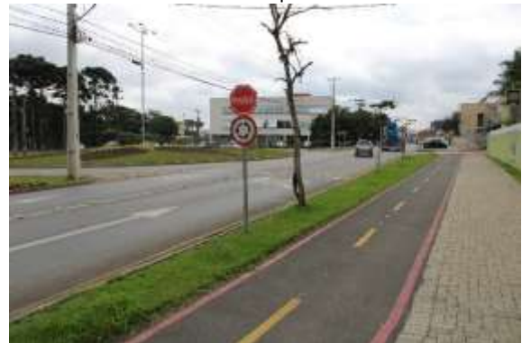
Figura 67: Exemplo de ciclovia no mesmo nível do passeio em Piraquara
