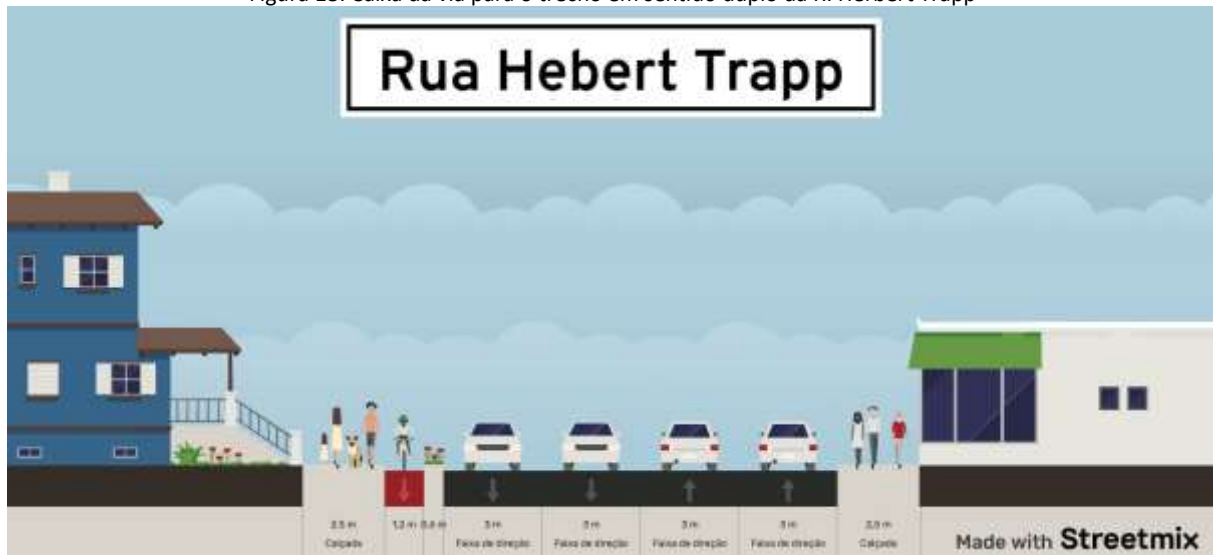
Figura 18: Caixa da via para o trecho em sentido duplo da R. Herbert Trapp
